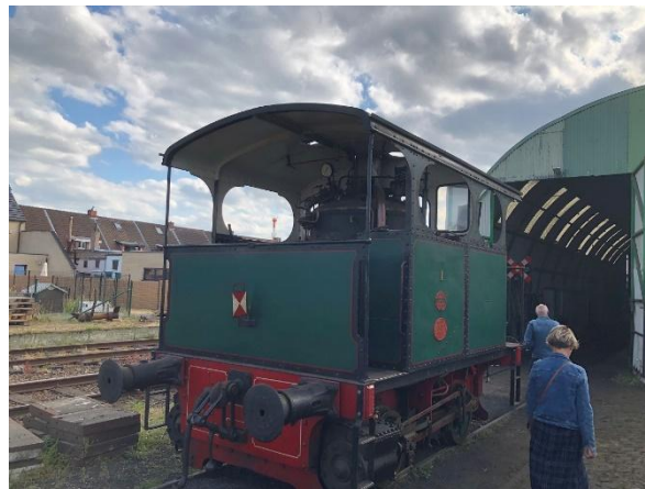
Locomotive à chaudière verticale Cockerill 1907
