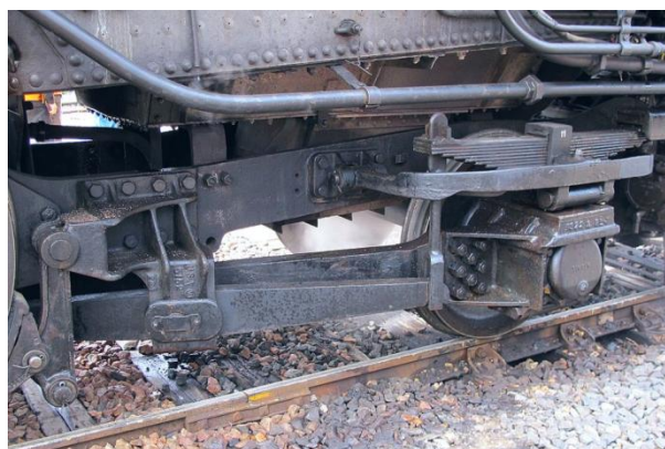
Ci-contre : Le bissel américain type « Cole » d'une 141 R. Photo Wikipédia
