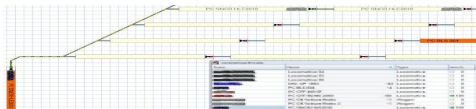
Exemple d'itinéraire tracé dans Train Controller pour emmener le train sur la bonne voie de garage
