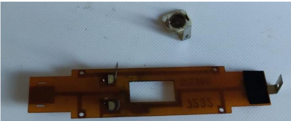
Pour s'assurer qu'il n'y ait pas de court-circuit, il est préférable d'ajouter un bout d'isolant sur l'attache du support.
