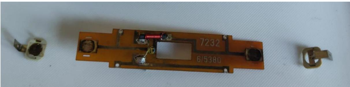
Sur la platine, les lampes sont directement alimentées par le courant des voies. Il faut les isoler. Pour cela, on détache les supports et l'on retire les bouts de graphite qui servent de diode en analogique.
