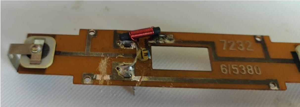
En analogique, le courant pris sur les voies va directement au moteur. Ce qui n'est pas le cas en numérique. Pour adapter la platine, il faut couper les deux jonctions apportant le courant.
