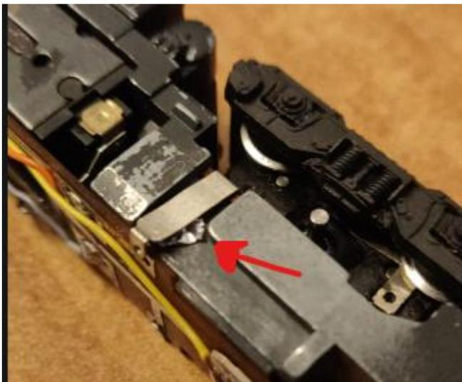
Comme l'arrivée du courant d'un des plots a été isolée de la bande lorsque l'on a sectionné la bande conductrice, le côté arrière droit du bogie n'alimente plus le circuit. Cela risque de poser problème dans les aiguillages. Mais heureusement, comme ce côté est lié à la masse, on peut simplement ajouter un bout de papier aluminium entre l'onglet et la locomotive.
