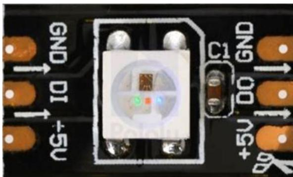
À noter que chaque «LED» est en réalité composée de trois diodes électroluminescentes (une rouge, une verte et une bleue) et d'un minuscule circuit intégré qui interprète les ordres donnés au ruban, et allume chacune des LED en fonction de ces ordres. Cela permet, par combinaison des trois couleurs de base, de générer des millions de couleurs (un peu comme sur votre téléviseur couleur).
