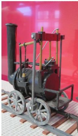
Pour ce modèle, les roues étaient actionnées par une bielle directement reliée à une tige actionnée par le piston. Le circuit construit en fonte ne supporta pas le poids de la locomotive, ce qui provoqua un déraillement du convoi et l'échec de la tentative. Au cours des années qui suivirent apparurent d'autres modèles de locomotives à vapeur peu concluants.
